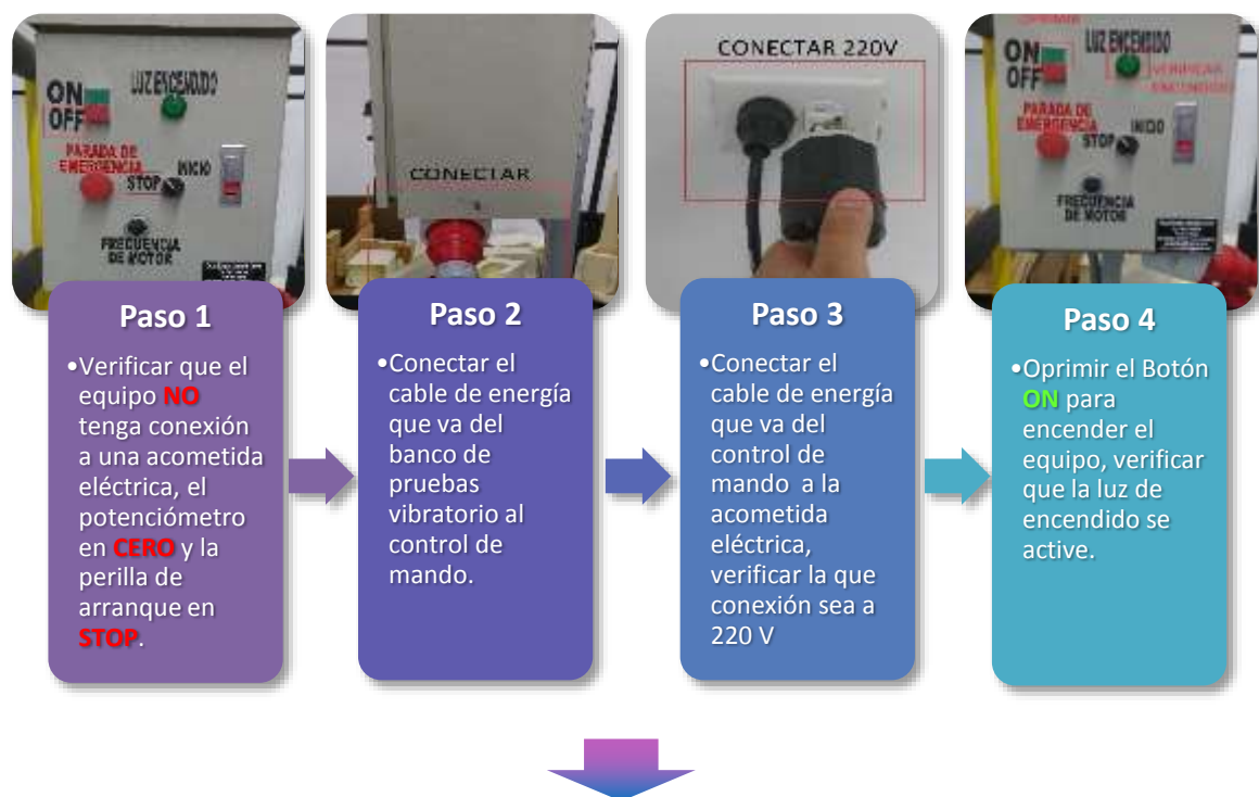
Figura 4. Pasos para la preparación de la fuente generadora de vibraciones
