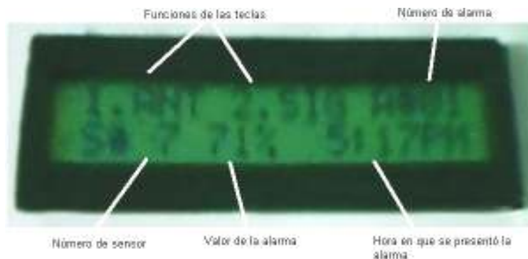
Figura 38. Registro de alarmas
