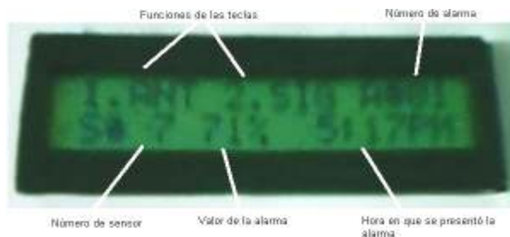
Figura 27. Registro de alarmas
