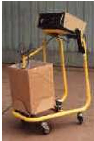
Figura 25. Dispositivo de pintura electrostática SIEPH 1 S4
