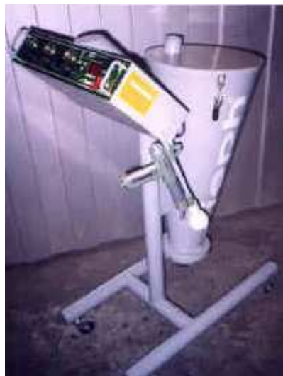
Figura 24. Dispositivo de pintura electrostática SIEPH 2011
