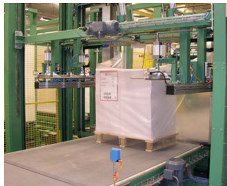
Figura 8. Ejemplo de plataforma en proceso de embalaje con material TERMOENCOGIBLE
