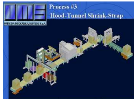
Figura 7. Plástico en Bolsa, Horno en Anillos, Presión, Zunchado.
