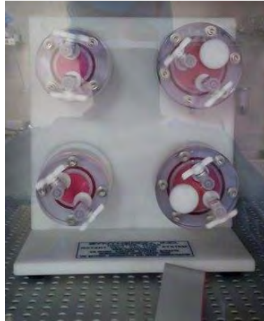
Figura 13. Biorreactor con los vasos sanguíneos, células y medio
