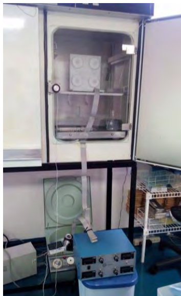
Figura 12. Montaje del biorreactor dentro de la incubadora
