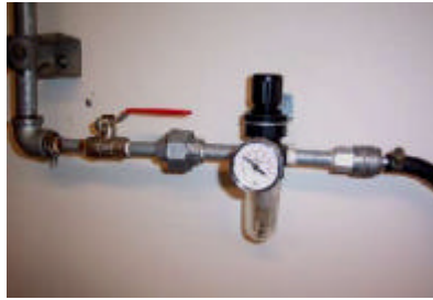
Detalles del sistema neumático. Toma de aire comprimido y pistón neumático (Actuador de disparo remoto).
