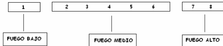
Figura 2. Distribución de los puntos para el análisis de gases de combustión de la caldera.
