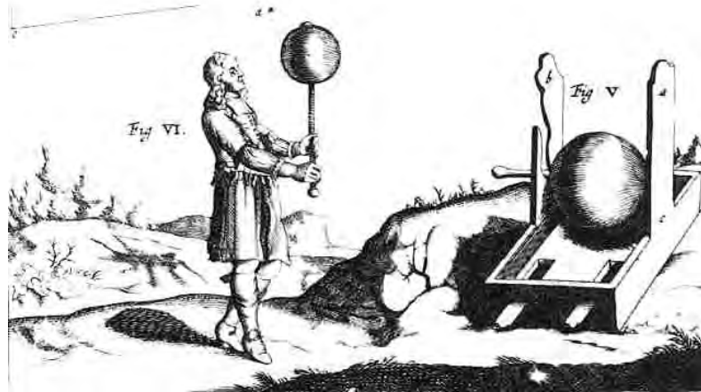
FIGURA 1. Generador eléctrico de Guericke
