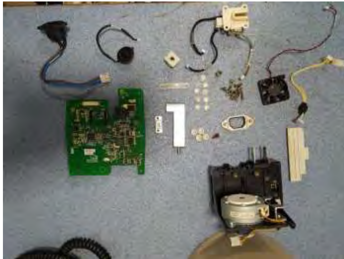
Fig. 24. Partes funcionales y reutilizables de la bomba de infusión dada de baja.
