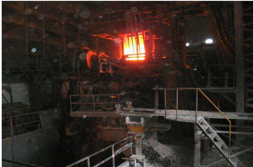
Figura 5. Proceso de Colado de la Chatarra del Horno Cuchara.
